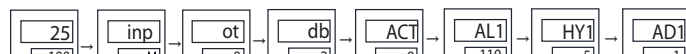
1. 将SV目标值 设置 100 2. 将INP菜单 设置 K 3. 将OT菜单 设置 0 4. 将DB菜单 设置 2 5. 将ACT菜单 设置 0 6. 将AL1菜单 设置 110 7. 将HY1菜单 设置 5 8. 将AD1菜单 设置 1
